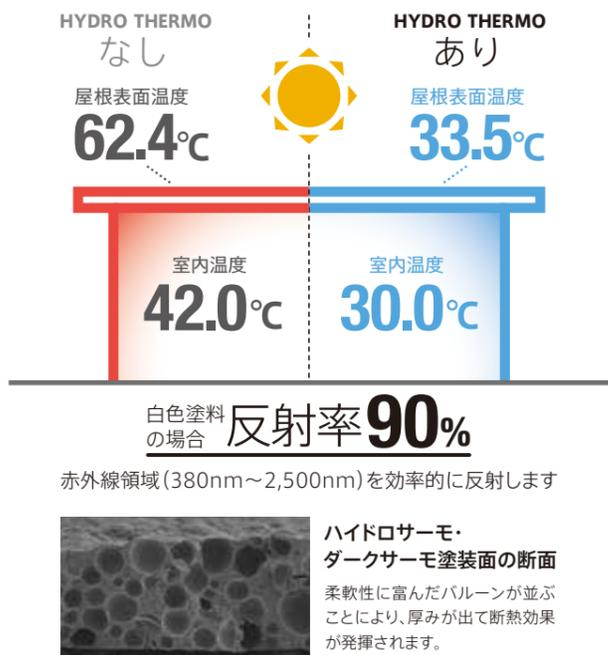
遮熱・断熱2つの効果で室内温度の低下
