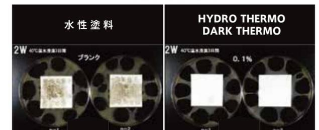
試験方法: JIS-Z-2911カビの抵抗性試験方法、塗料の試験に準じる
